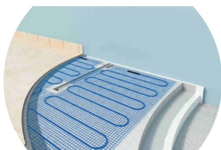
Rete scaldante posizionata nello strato di malta elastica o nel massetto autolivellante, o direttamente sotto nella colla delle piastrelle
